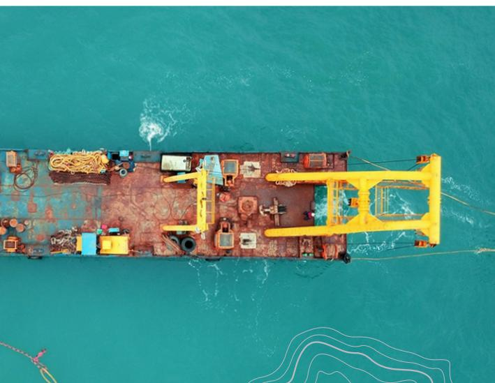
Utilizada em operações com montagens de estruturas portuárias, em içamento e reboque de estruturas emersas e submersas (cascos soçobrados, poitas, âncoras, derrelitos, entre outras) e em trabalhos de geotecnia em áreas abrigadas, atuando como plataforma de sondagem.
