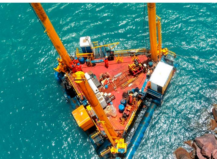
Devido à sua capacidade de elevação em relação à lâmina d'água, por meio do cravamento dos spuds no solo, mantém a estabilidade e a posição mesmo na presença de ondas, permitindo a execução de sondagens com alta precisão.
