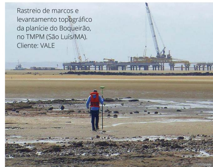
Rastreio de marcos e levantamento topográfico da planície do Boqueirão, no TPM (São Luís/MA). Cliente: VALE
